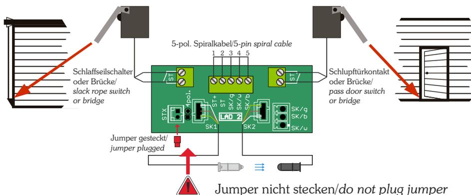
Hinweis/note 2: Beim Einsatz eines Jumpers in Verbindung mit einem 5-pol. Spiralkabel, besteht Kurzschlussgefahr für die Steuerung. Ausschließliche Anwendung nur beim Einsatz von einem 4-pol. Spiralkabel./
