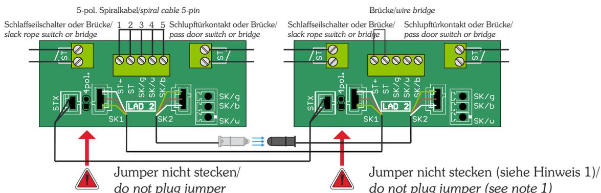
Hinweis/note 2: Beim Einsatz eines Jumpers in Verbindung mit einem 5-pol. Spiralkabel, besteht Kurzschlussgefahr für die Steuerung. Ausschließliche Anwendung nur beim Einsatz von einem 4-pol. Spiralkabel./
