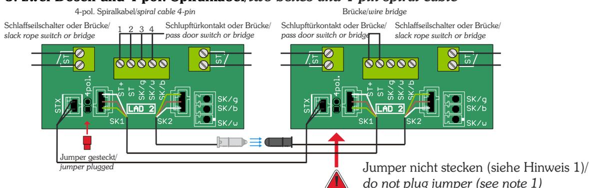
Hinweis/note 1: Beim Einsatz des Jumpers in der Verbindungsdose, werden die Schlafseilschalter/Schlupftürkontakte in der Hauptanschlusssdose gebrückt. Diese Kontakte sind dann trotz angeschlossener Schalter ohne Funktion./When the jumper is used in the connection box, the slack rope switches/pass door switches are bridged in the main connection box. These contacts are then out of function despite the connected switches.
